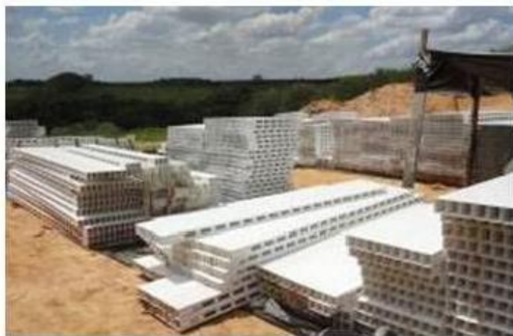
FIGURA 18 – Painéis de PVC pré-moldados na fábrica
