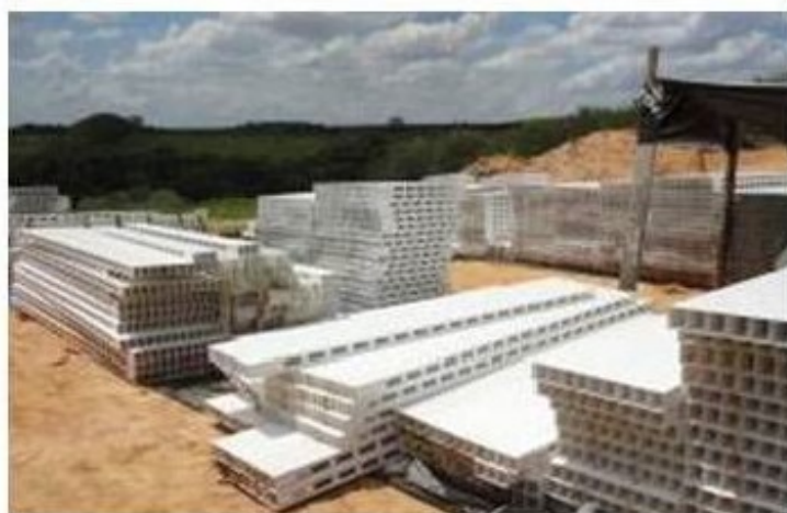
FIGURA 11 – Painéis de PVC pré-moldados na fábrica
